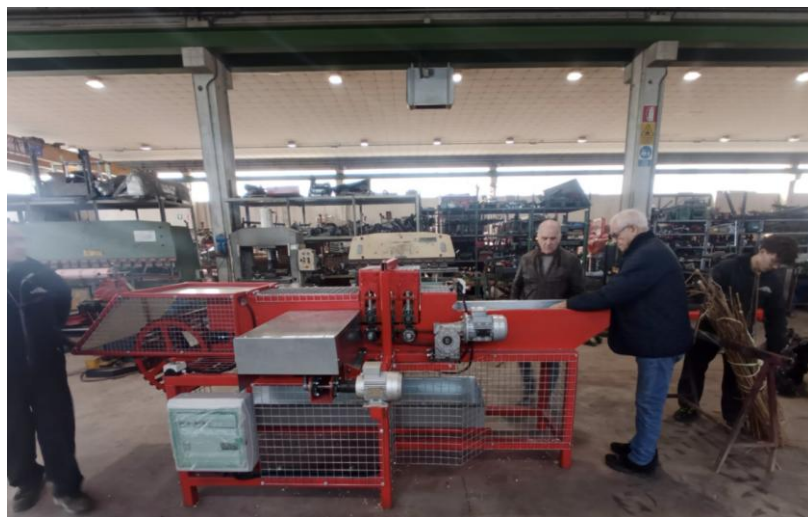
- II macchinario, di dimensioni aziendali separa la parte legnosa della pianta dalla fibra (parte di interesse tessile). - I sottoprodotti (canapulo) ottenuti si possono utilizzare per altri scopi.
