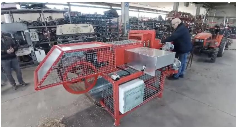
- Prototipo per la stigliatura della canapa costruito dalla ditta SPAPPERI N.T. S.R.L. con sede a Città di Castello (PG)
