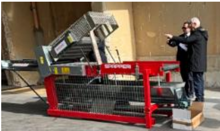
- 2° Prototipo per la stigliatura della canapa MODIFICATO dalla ditta SPAPPERI N.T. S.R.L. con sede a Città di Castello (PG)
